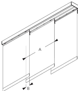
A: largeur de panneaux recommandée: 500-1200 mm
