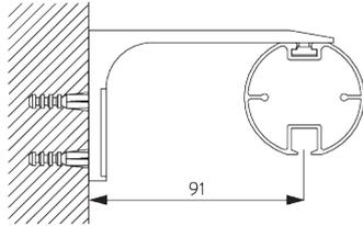
Vis SG 10492 (M4x8) nécessaire.
